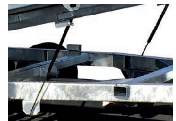
Basculement par 2 verins à gaz renforcés
